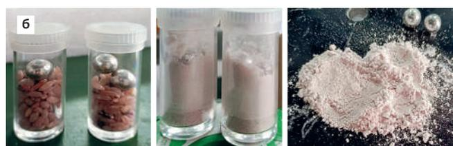
Рис.11. Подготовка растительных образцов методом QuEChERS на RayKol V20: а – гомогенизация ягод дерезы обыкновенной (*Lycium barbarum*); б – измельчение не очищенного от отрубевой оболочки зерна риса (*Oryza sativa*)
