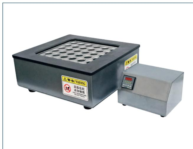
Рис.5. Графитовый нагревательный блок RayKol M36
