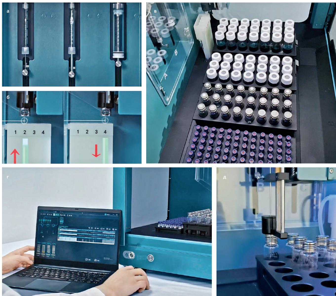
**Рис.8.** Технологии, реализованные в RayKol AP 300, делают процедуры дозирования и разбавления простыми и удобными: а – высокоточные шприцевые насосы на 100 мкл, 1 мл и 10 мл; б – станция многократной промывки игл; в – платформа для образцов с модулями охлаждения и перемешивания и возможностью работы с пробирками разного размера; г – управление с ПК по Wi-Fi; д – высокоточный модуль для отбора проб
