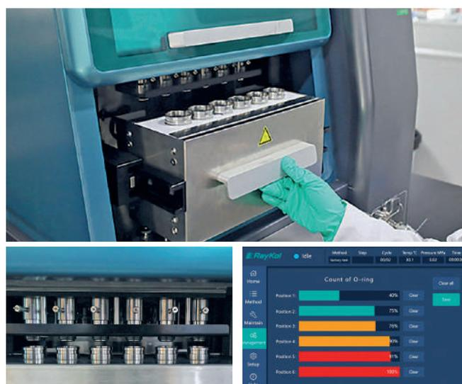
Рис.13. Модуль нагрева RayKol HPFE 06, внизу справа – индикация ресурса уплотнительных колец экстракционных ячеек
