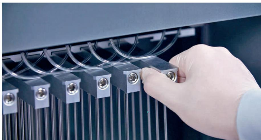
Рис.15. Оригинальная запатентованная игла из нержавеющей стали обеспечивает одинаковую скорость и строго вертикальное направление потока газа по центру пробирки. Внизу: извлечение игл для очистки не требует специальных инструментов
